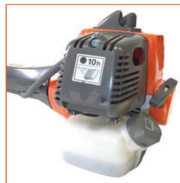
**“Primer”** sur le carburateur, facilite le démarrage à froid après les ravitaillements en carburant ou une longue période d’inactivité.
